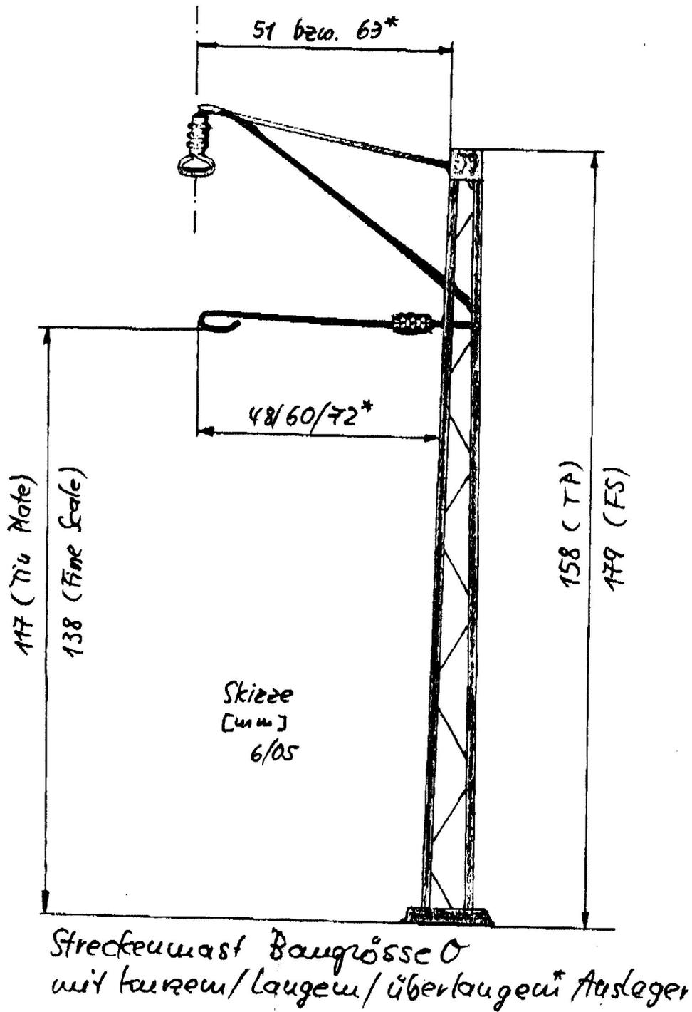
Im folgenden Bilder der Streckenmaste mit einer Höhe von 179 mm
