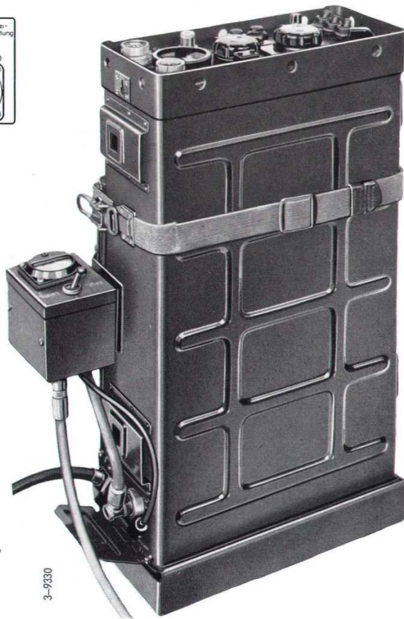
Bild 120 SE-Gerät FuG 7a im Montagerahmen (Roverhalterung) und daran befestigtem Abstrahlzeiger.
