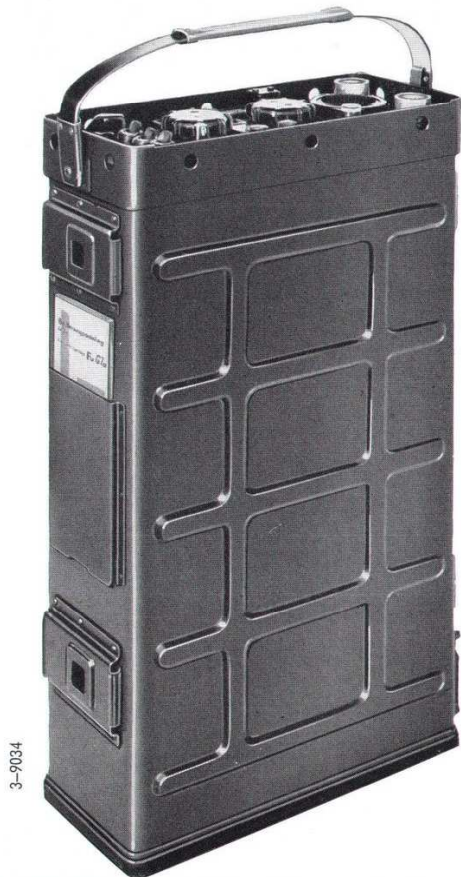
Bild 103 SE-Gerät FuG 7a mit Tragegurt und eingesteckter Bedienungsanleitung AH/Bs-V 300626
