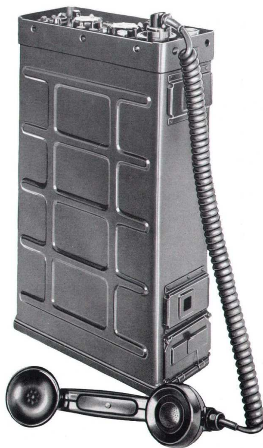
Bild 97 Funksprechgerät FuG 7a mit angeschlossenem Handsprechhörer
