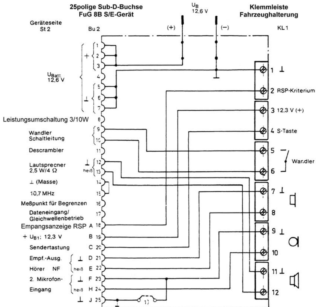
1) Bei Anschluß eines Mikrofons an der Geräteblock-Rückseite: Auf Leiterplatte der Halterung Brücke einlegen.
