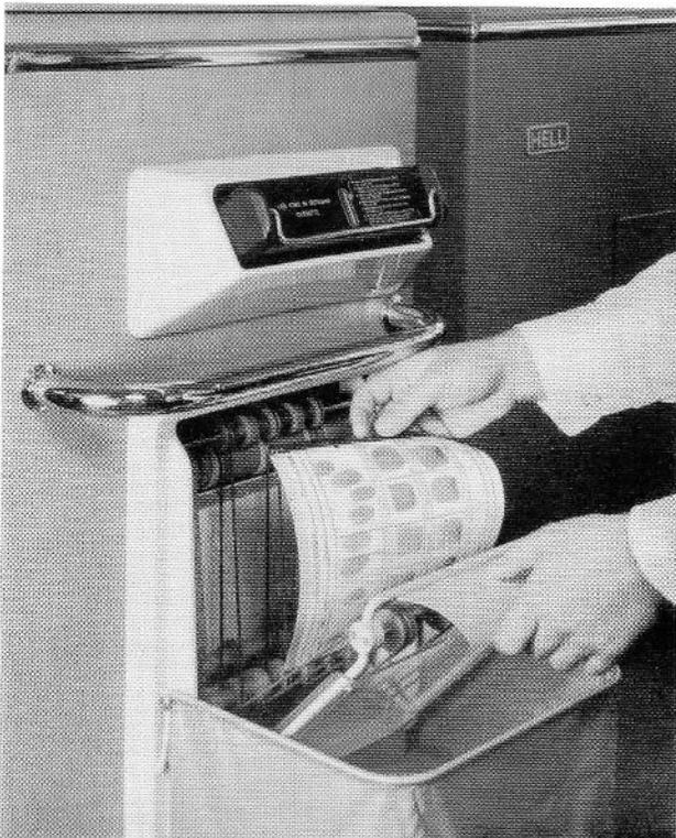
Der Hell-Telebild-Empfangsautomat TM 832 dient der Aufzeichnung von Telebildern und Texten, die von Telebild-Sendestellen überwiegend über Fernsprechverbindungen übertragen werden. Mit Hilfe geeigneter Funkempfangsanlagen lassen sich Bildsendungen auch drahtlos empfangen (Einzelheiten über die gegebenen Möglichkeiten werden auf Anfrage mitgeteilt.) Die bei der Polizei einzusetzenden Hell-Telebild-Empfangsautomaten TM 832 sind für vollautomatischen Bildempfang eingerichtet.
