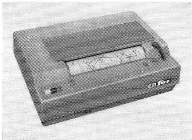
Vorlagen: bis max. 216 x 300 mm (DIN A 4) bzw. 8<sup>1</sup>/<sub>2</sub> x 12". Auflösung 4 Linien/mm. Trommeldrehzahl 180 U/min, Modul 264. Die Übertragungszeit für 1 Seite im Format DIN A 4 beträgt ca. 6,5 Minuten.
