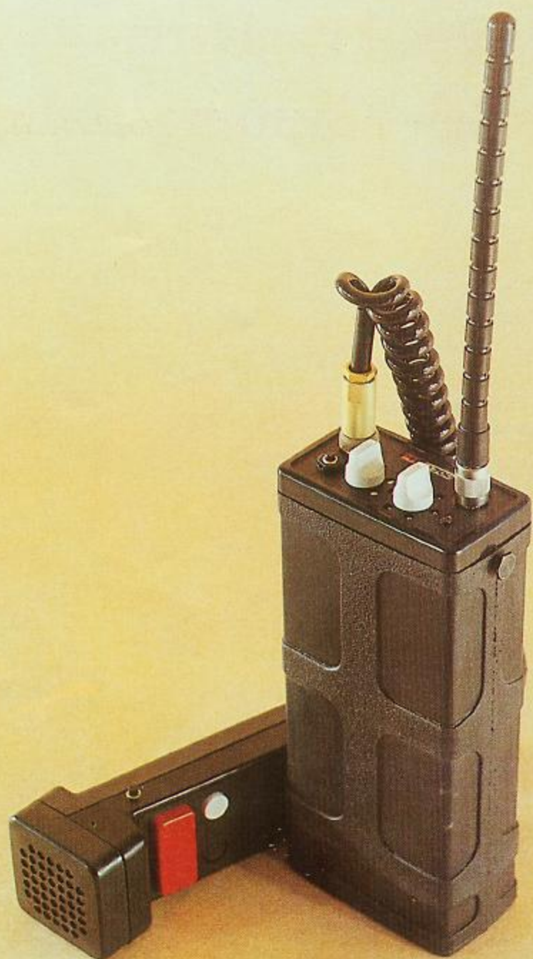
Sende-Empfangsgerät UFT 771, Bedienteil UBT 70.1
