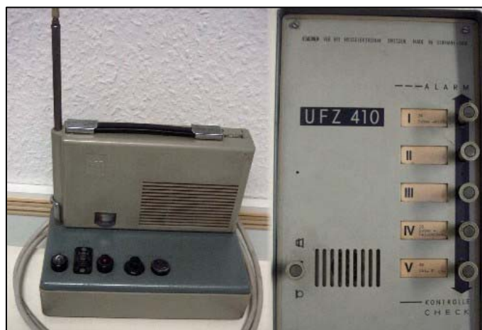
Empfangsteil und Sendeteil mit integriertem Mikrofon der UFT 212
